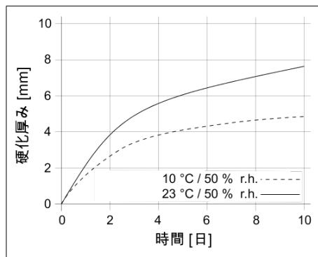
グラフ 1: Sikaflex®-521 UVの硬化速度
