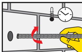
9. Inserte el anclaje con un movimiento rotatorio en el orificio de perforación lleno dentro del tiempo abierto del adhesivo. Parte del adhesivo debe salir por el agujero
