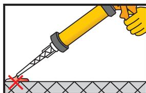
7. Bombee la pistola por lo menos 2 veces hasta que ambas partes se mezclen en un solo color consistente. No utilice esta material. Suelte la presión de la pistola y limpie la abertura del mezclador estático con un paño.
