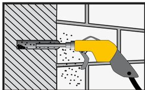
2. El orificio de perforación debe limpiarse con aire comprimido sin aceite utilizando una lanza de aire, presión: 6 bar (90 psi). Empiece desde el fondo del agujero y limpie por lo menos 2 veces hasta que la corriente de aire de retorno esté libre de polvo.
