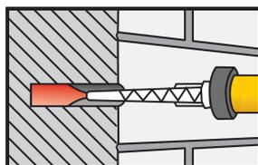
8. Inyecte el adhesivo en el orificio de perforación, empezando por la parte interior y extraiga lentamente el mezclador estático mientras extruye la resina en el orificio. Evite que quede aire ocluido en el interior. Para agujeros profundos, utilice un tubo de extensión
