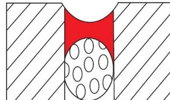
Durch die nach unten versetzte Fuge wird der Dichtstoff vor mechanischer Belastung geschützt
