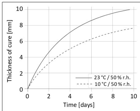
Diagramm 1: Durchhärtengeschwindigkeit Sikaflex®-515
